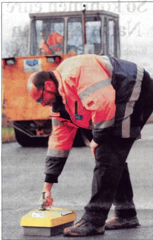
Bautechniker Carlos Diniz Guedes aus Dreihausen arbeitet am radioaktiv strahlenden Messgerät. Es kostet 25 000 Euro.
